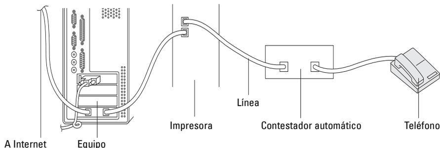
Si desea usar el módem de su ordenador para enviar faxes o establecer una conexión por marcado a Internet, conecte el módem del ordenador directamente a la parte posterior de la impresora con el contestador automático, como se indica arriba.
