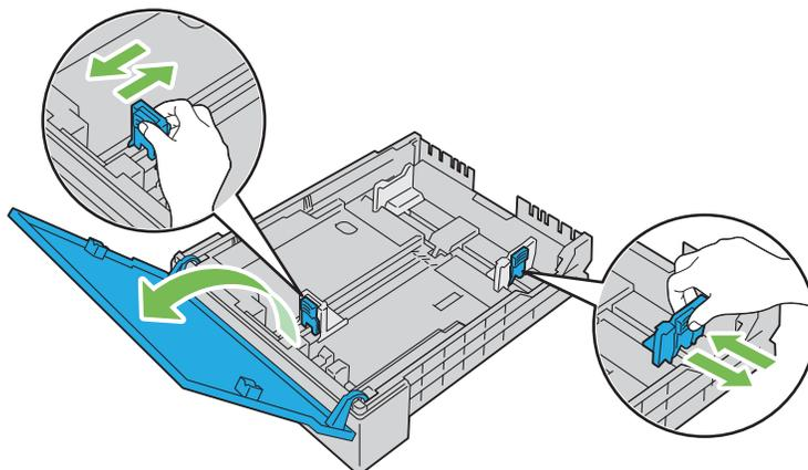
**NOTA:** Al cargar soportes de impresión de tamaño legal o con un tamaño especificado por el usuario, extienda la parte extensible de la bandeja presionando la palanca al mismo tiempo.
