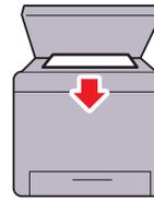
Puede escanear las páginas de un libro o un folleto con el cristal del escáner. Al escanear documentos usando el cristal del escáner, colóquelos boca abajo. Para obtener más información, consulte "Hacer Copias Desde el cristal del escáner" en la página 198.
