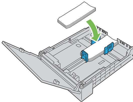
**PRECAUCIÓN:** No utilice nunca sobres con ventanas o revestimientos encapados, ya que podrían ocasionar atascos de papel y estropear la impresora.
