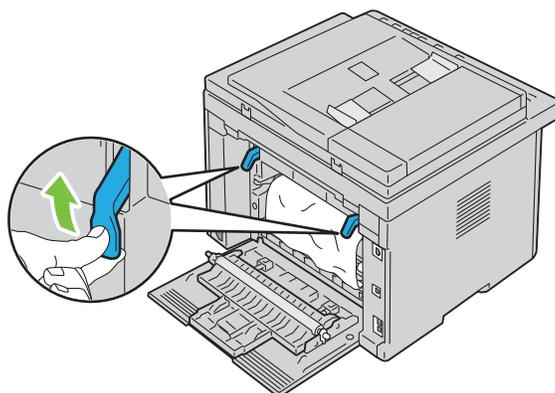
**3** Retire cualquier papel atascado de la parte posterior de la impresora. Si no encuentra ninguna hoja en la trayectoria del papel, sitúese en la parte delantera de la impresora y compruebe la bandeja de salida.
