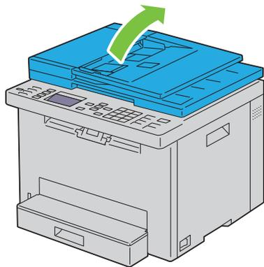
**3** Limpie la superficie de cristal del escáner y el cristal del ADF hasta que esté limpia y seca.
