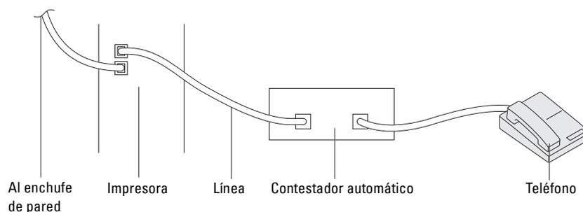
Se puede conectar un contestador automático directamente a la parte posterior de la impresora, como se muestra arriba.
