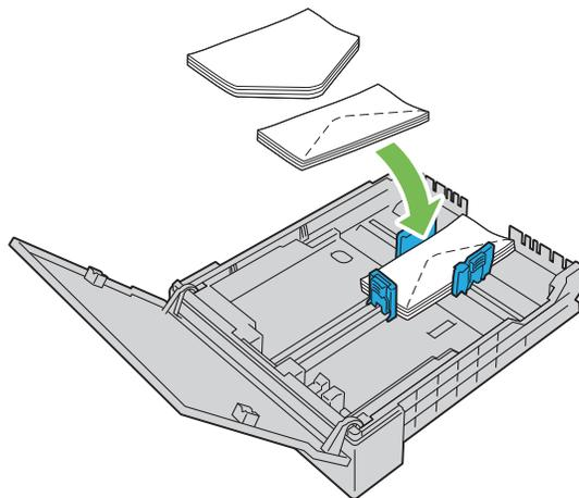
Para evitar que los formatos DL y Monarch se arruguen, se recomienda colocarlos con las solapas abiertas. Coloque el lado de impresión hacia arriba y compruebe que las solapas quedan en la parte inferior al ponerse delante de la impresora.
