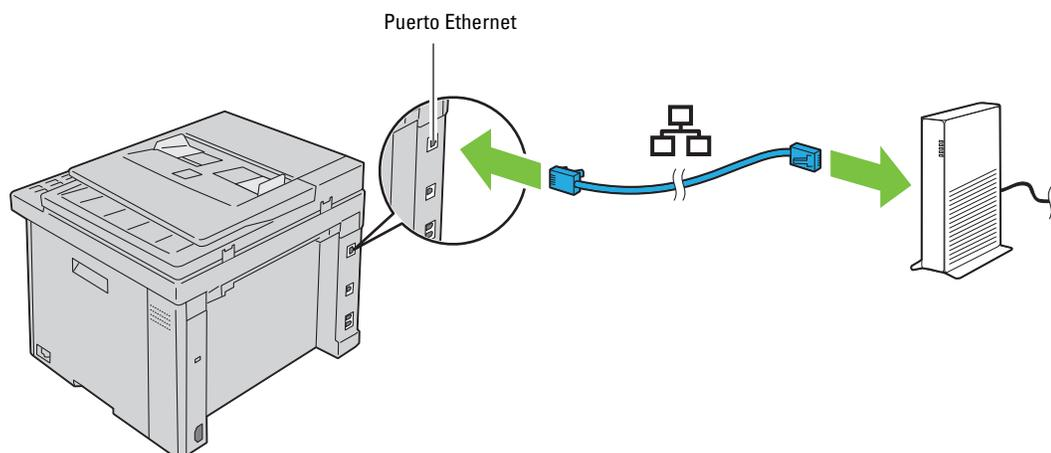
**NOTA:** Conecte el cable Ethernet solo cuando necesite establecer una conexión por cable.
